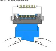
上方向に引抜きますとモールド破損の恐れがありますので、
